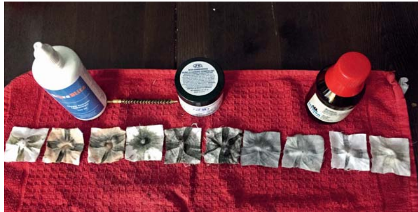
Die schmutzigen Baumwollpflaster zeigen nach dem Durchziehen, was alles im Lauf gesteckt hat.
