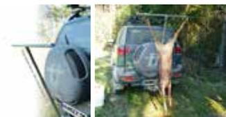
Höhenverstellbar sowie schnell und einfach zu montieren, wird problemlos an der Anhängerkupplung befestigt. Sie verhindert, dass Panseninhalt und Schweiß die Keulen verunreinigt. Die variablen Aufnahmen sind zum Einhängen der Haken am Querrohr geeignet, z. B. zum Aufbrechen von Reh- und Schwarzwild, höhenverstellbar von ca. 130 cm bis ca. 180 cm. Platzsparend in jedem Kofferraum unterzubringen. Gewicht: ca. 5,8 kg **109,00 €**
